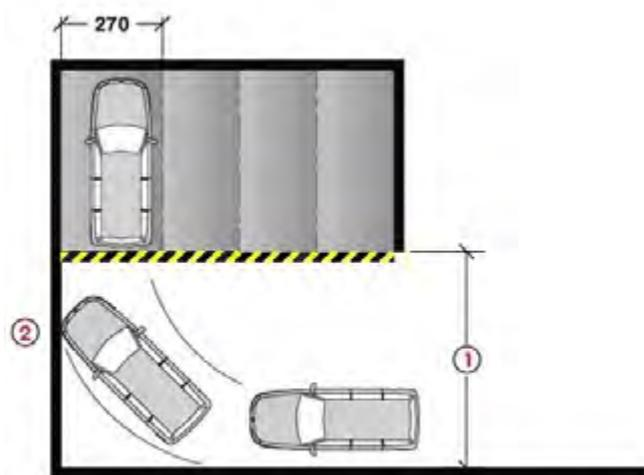
Die Parkplattform mit einer lichten Breite von 230 cm ermöglicht das Einparken von Fahrzeugbreiten bis max. 190 cm (mit eingeklappten Spiegeln). Für die regelmäßige Nutzung empfehlen wir eine Plattform mit der lichten Mindestbreite von 250 cm. Eine Plattform mit der lichten Breite von 270 cm garantiert unseren Nutzer den höchsten Komfort.
